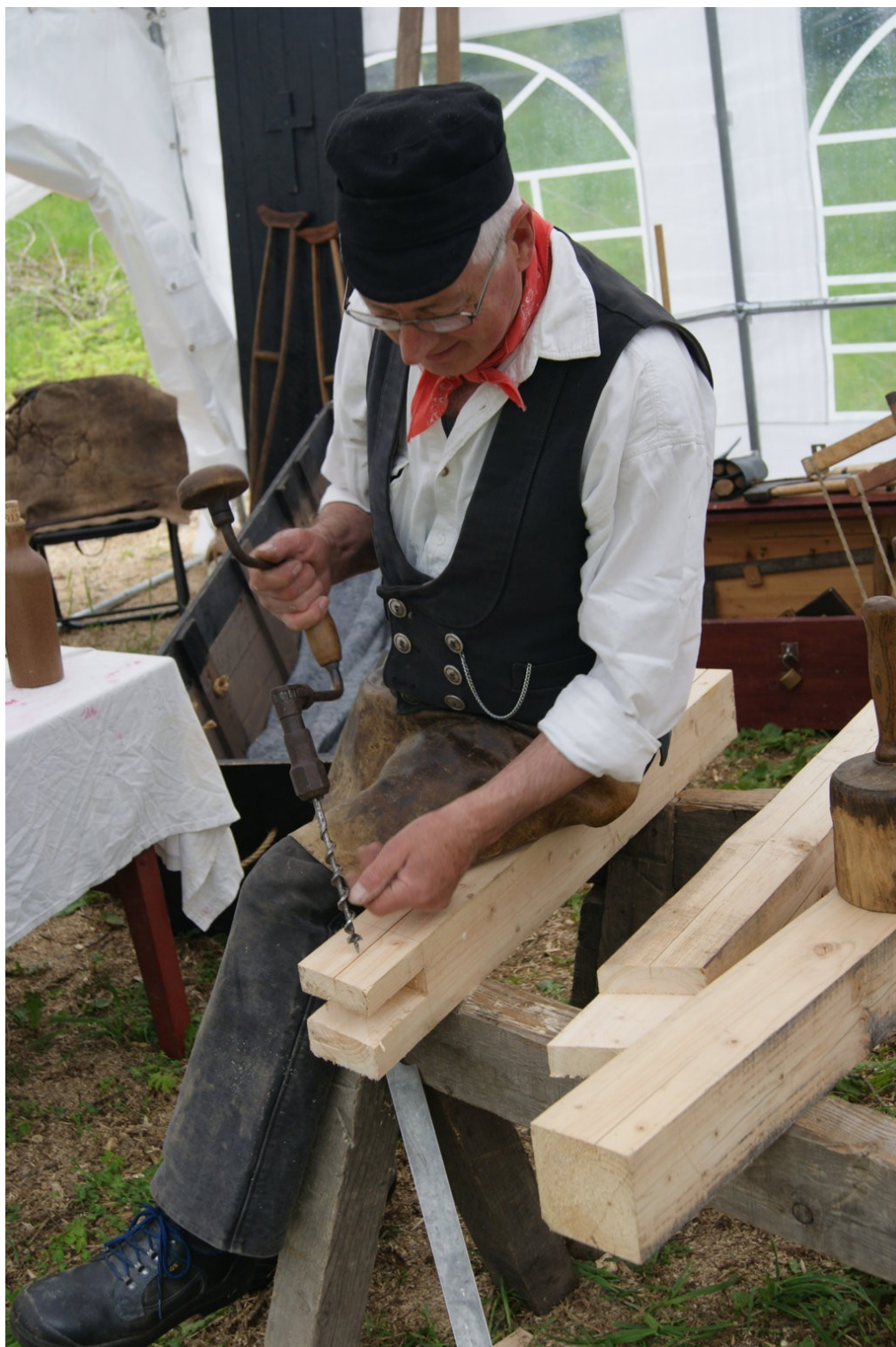
Skal man tappe tømmer sammen til et bindingsværkshus skal man Tømrer Erik Therkildsen, han kan det der med håndværkstøjet. Her er det et vridbor han har fat i for at lave et taphul.
